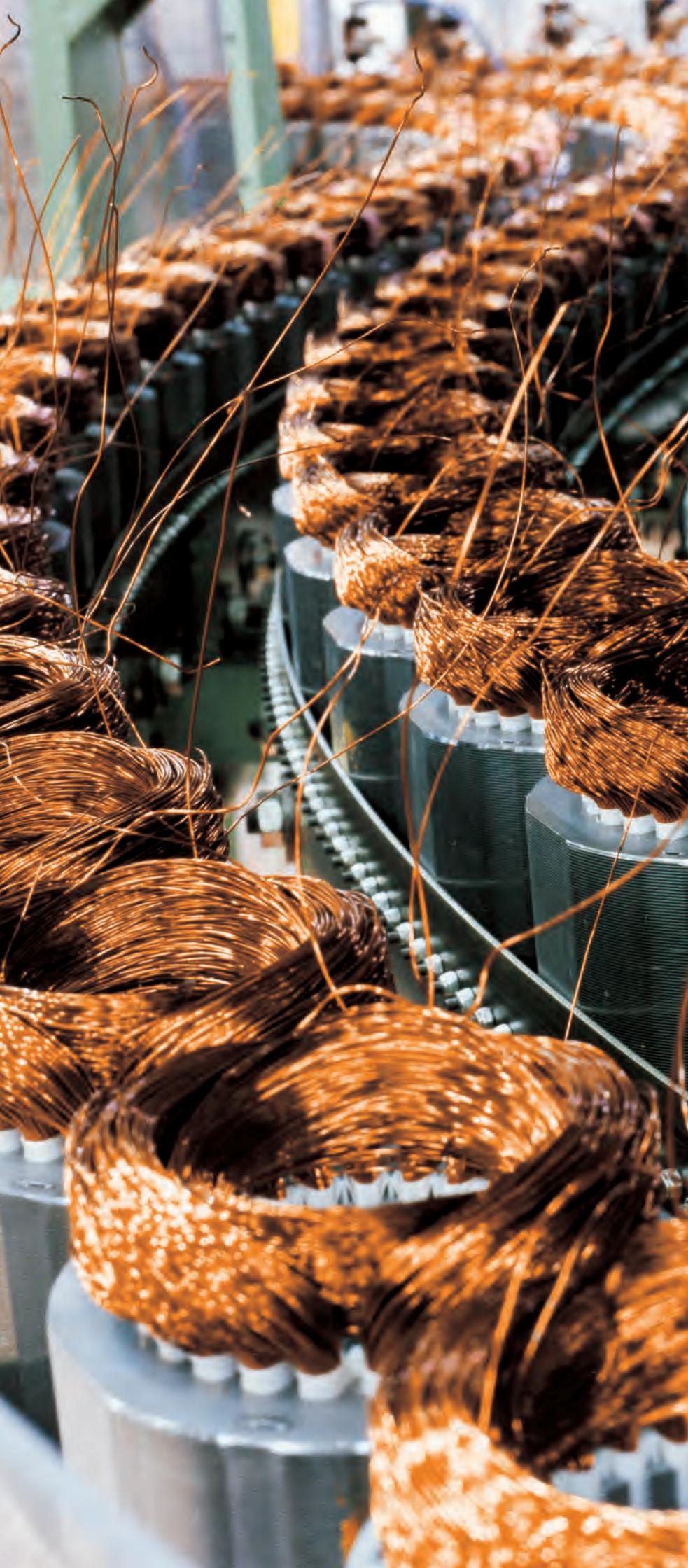
El corazón de la electrobomba es el motor eléctrico. Por lo tanto es necesario garantizar no solo la mejor calidad de los componentes utilizados, sino también que la ejecución en las varias fases del embobinado (aislamiento, embobinado, impregnación, etc.) ocurra con las más avanzadas máquinas automáticas, para garantizar la precisión y la constancia en todos los procesos productivos.
